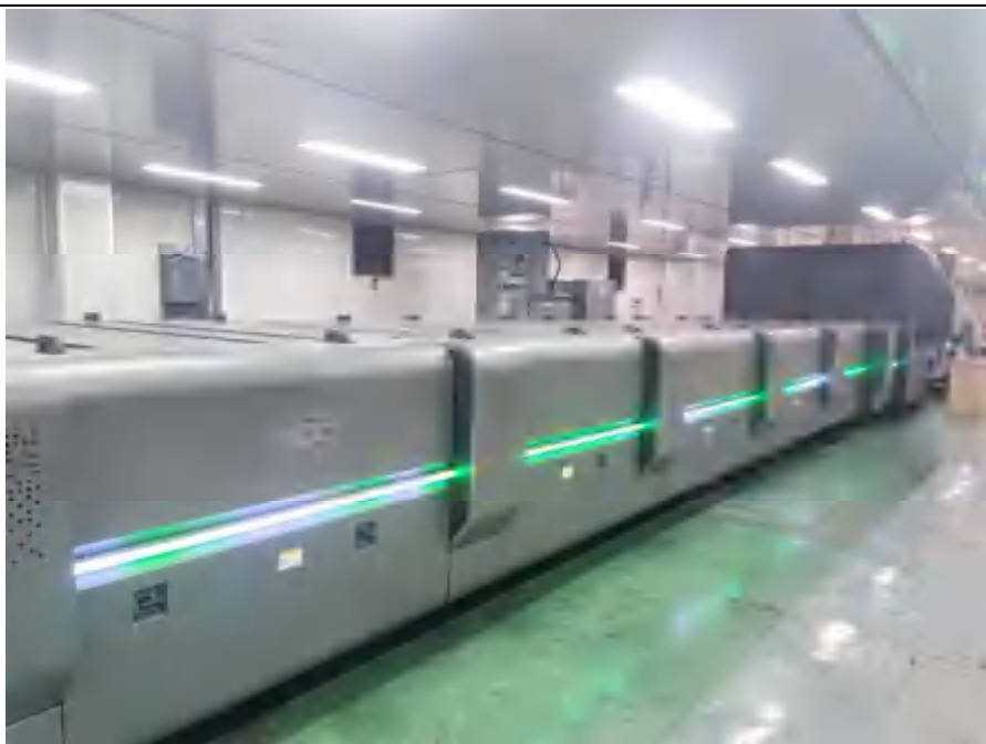
图 2-7 EBC-ORG-A-8015 型低能电子束辐照装置外观图
