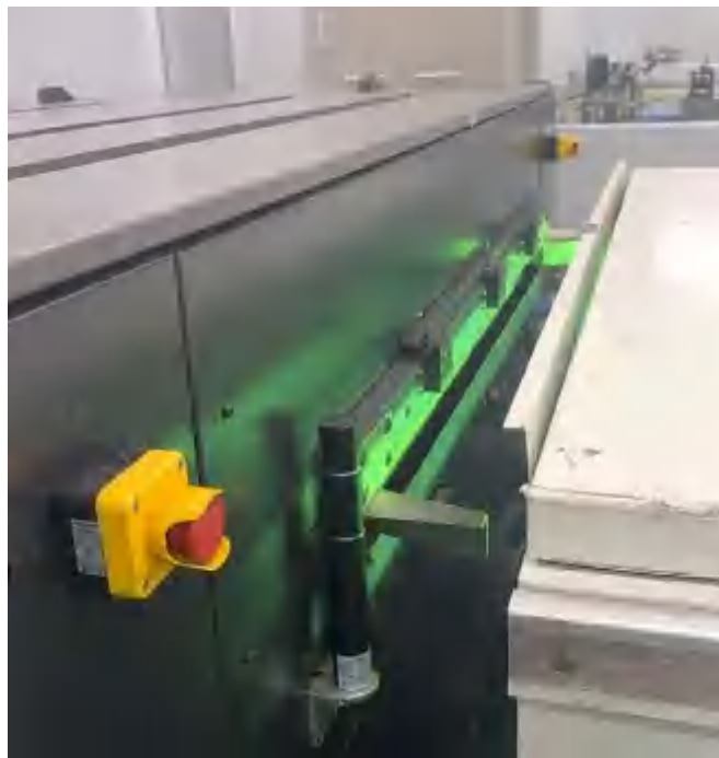
图 3-8 屏蔽结构运动、距离传感器联锁
